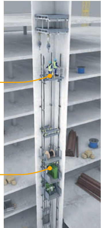
Mobiler Maschinenraum mit Trenndeck
